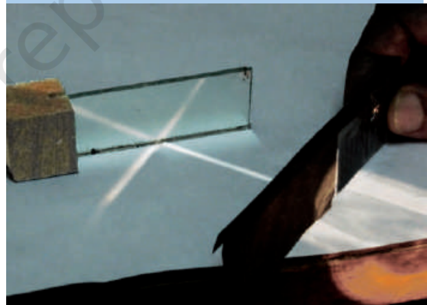
चित्र 16.1 : परावर्तन दर्शाने की व्यवस्था
